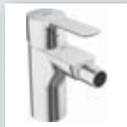
HANSALIGNA однорычажный смеситель на одно отверстие, DN 15 0606 3203 хромиров. для биде, сливной гарнитур, Подключение через гибкие шланги G 3/8 выступ: 100 мм
