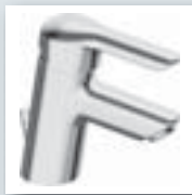
HANSAVANTIS Новинка однорычажный смеситель для умывальника, DN 15 5240 2273 хромиров. сливной гарнитур, Подключение через гибкие шланги G 3/8 выступ: 102 мм
